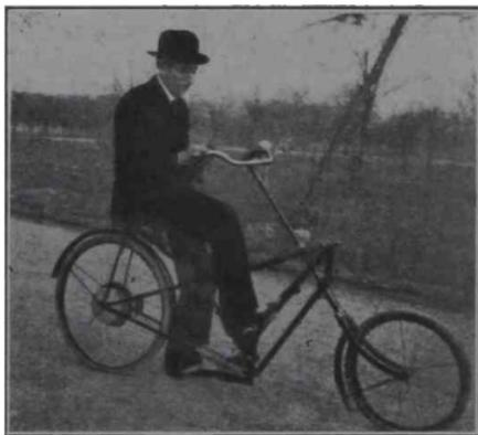
Cada una de estas llaves corresponde a una multiplicación distinta y el movimiento de las piernas se reduce a un movimiento de presión, los pedales pueden funcionar alternativamente o simultáneamente.
